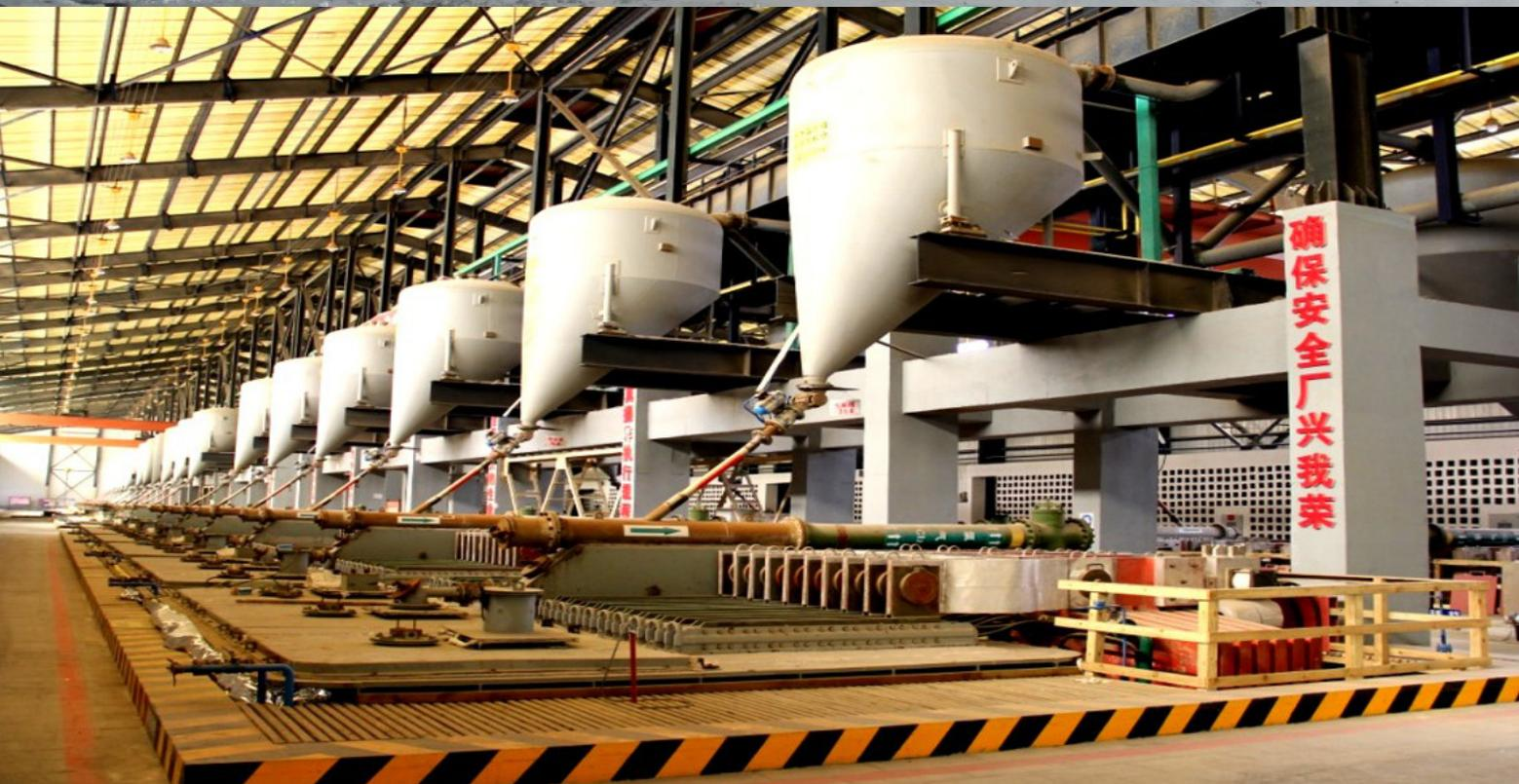
“盐湖镁业电解镁厂采用世界上最先进的自动化连续生产工艺。一期项目年设计产能10万吨纯镁。图示为电解车间一角,在电解槽内,氯化镁原料被电解成氯气和液态纯镁金属。”
